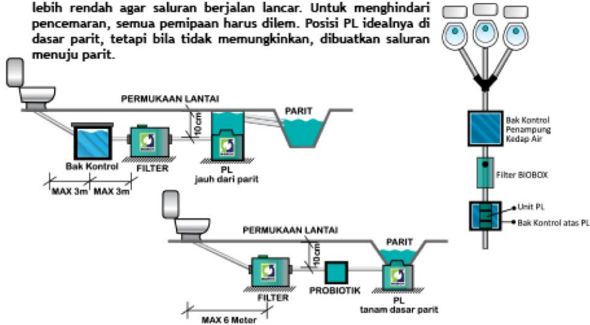
GAMBAR FILTER JAUH DI BAWAH PERMUKAAN TANAH MENGGUNAKAN SAMBUNGAN PIPA PANJANG
